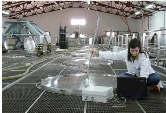
Mesure du potentiel libre sur une cuve
